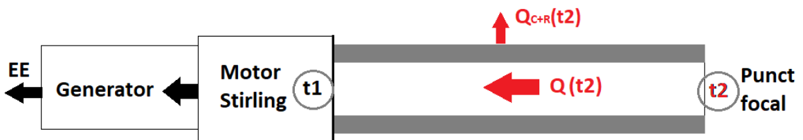
Figura 2.5. Sistemul energetic al unui concentrator solar parabolic
