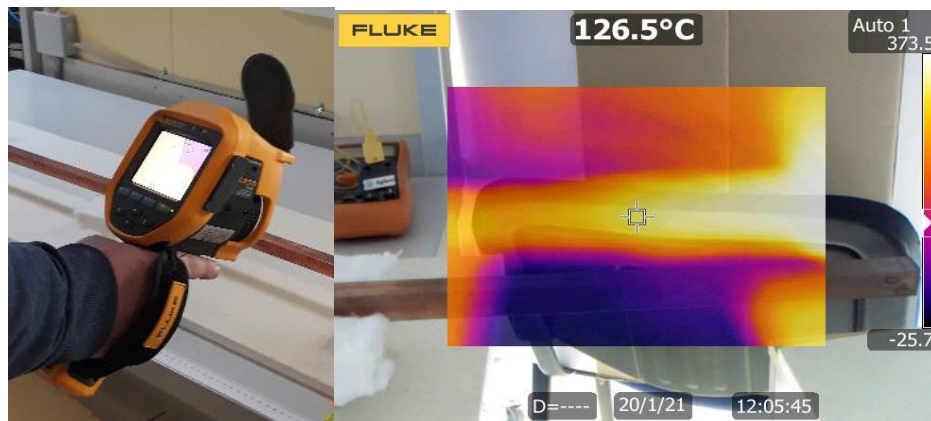
Figura 2.4. Camera de termoviziune Ti FLUKE 400
