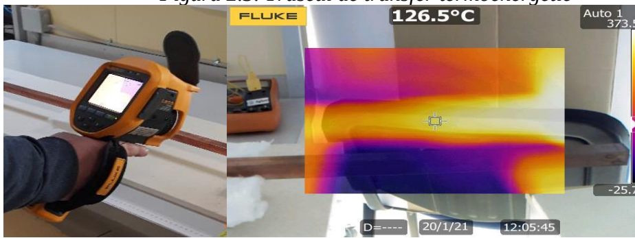
Figura 2.4. Camera de termoviziune Ti FLUKE 400
