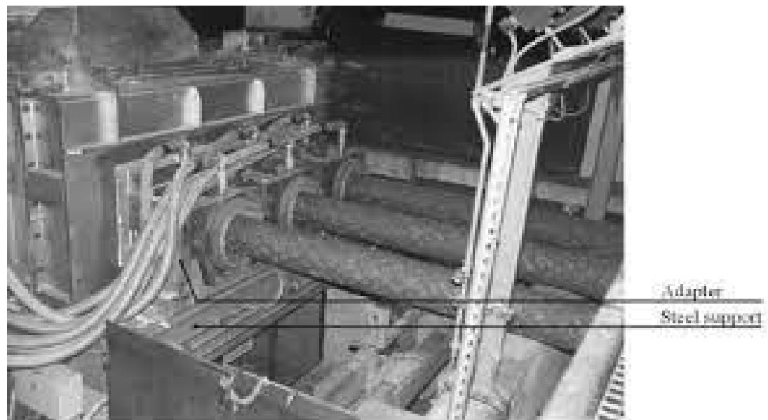
**Fig. 1.7. Instalatia de turnare continua a otelului pe orizontala cu trei fire**
