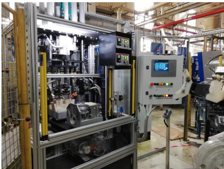
Fig. 15.1 - Sistem cyber-mecatronic ultra precis de control industrial și de laborator pentru repere auto turnate (implementat în linia de fabricație)
