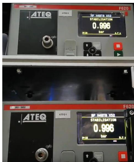
Fig. 14.2 - Stabilizarea circuitelor de presiune
