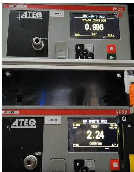
Fig. 14.3 - Test înaltă presiune/Stabilizare joasă presiune
