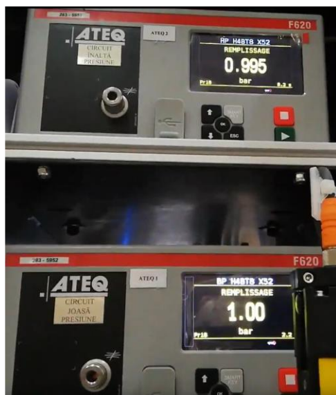
Fig. 14.1 - Umplerea circuitelor de presiune
