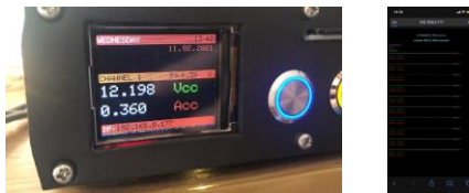
Figura 14. Valori înregistrate în timpul procesului de achiziție de date. Interfața web.
