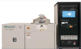
Figura 2. Sistem de depunere prin evaporare cu fascicul de electroni Temescal FC-2000.
