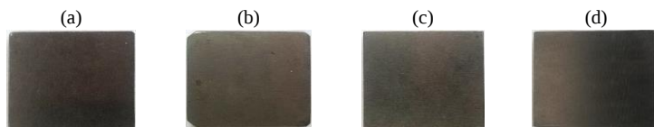
Figura 3. Substraturi de oțel pe care au fost depuse straturi metalice nanometrice utilizând evaporarea cu fascicul de electroni: (a) OLC45; (b) Rul1; (c) C120; (d) OSC.
