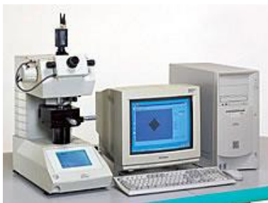
Figura 5. Sistemul automat de citire pentru testele de duritate Vickers.
