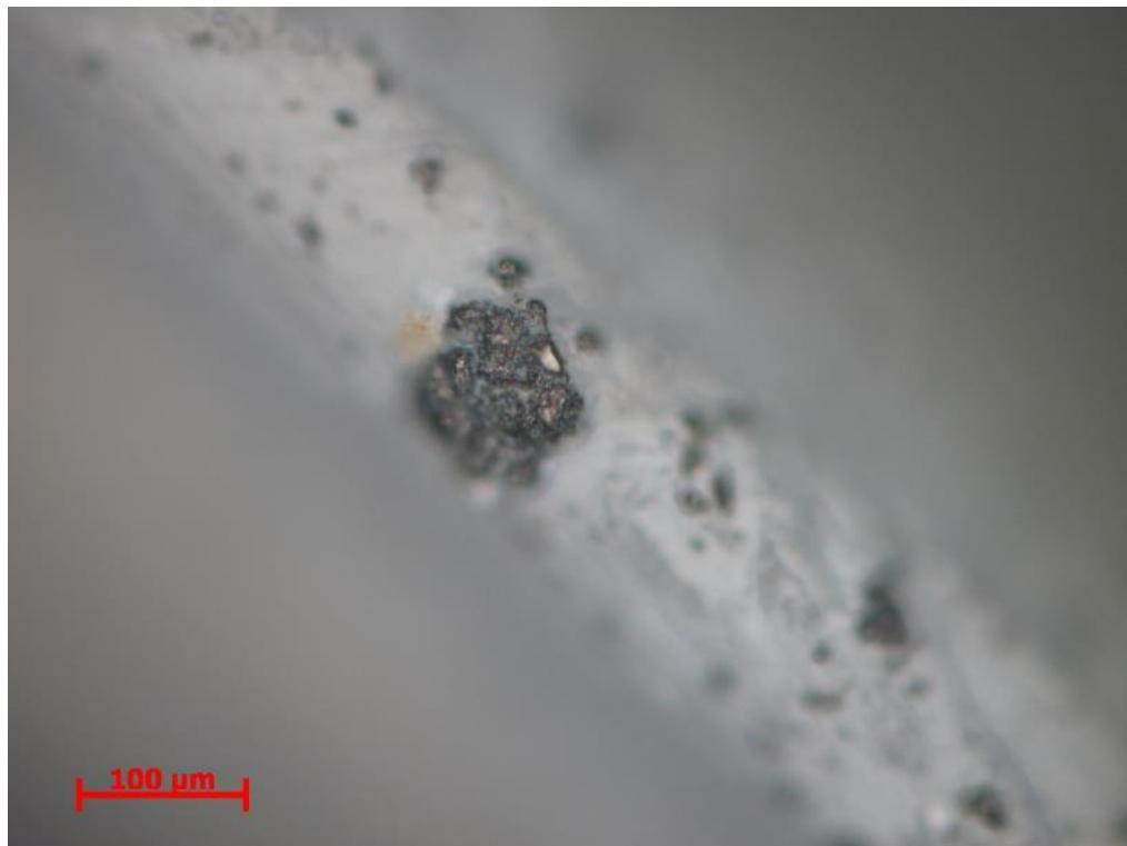
*Figura nr. 6.1 - Microscopie optică a implantului inovativ impregnat cu nanotuburi de carbon*
