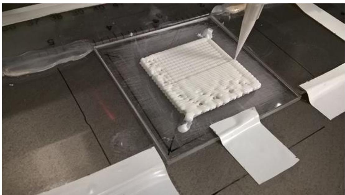
*Figura nr. 8.1: Bioprinting prin extruziune (Sistem SYS + ENG Bioscaffolder - laborator de cercetare INCD-IMNR)*
