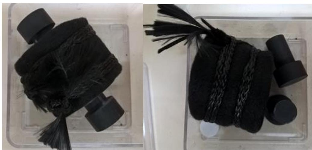
*Figura nr. 8.38 - Matrițele de grafit pentru sistemul de sinterizare cu arc electric în plasmă*
