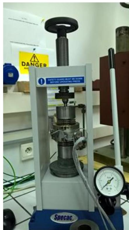
Figura nr. 8.7 - Configurarea experimentală a sinterizării hidrotermale
