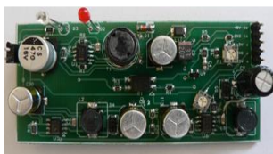
Figura nr. 7.5 - Plăcuța cu circuitul de alimentare și încărcare acumulatori
