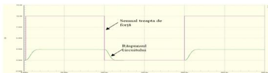
Figura nr. 6.11 - Răspunsul optim la semnal treaptă - fără oscilații
