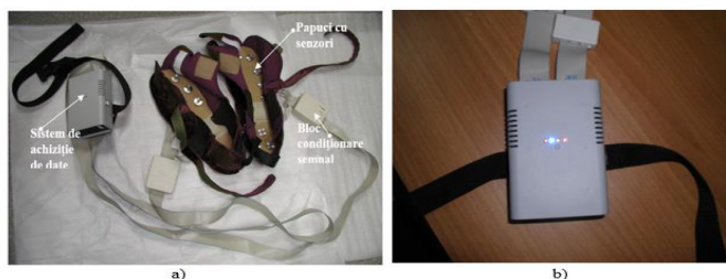
Figura nr. 7.7 - a) vedere generală b) detaliu unitate portabilă în timpul funcționării
