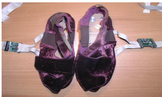
Figura nr. 7.8 - Suport cu senzori care se aplică peste încălțăminte
