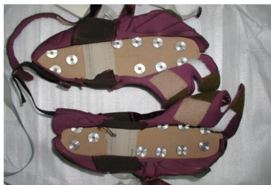
Figura nr. 7.2 - Vedere suportii cu senzori și a curelelor ce se aplică peste încălțăminte
